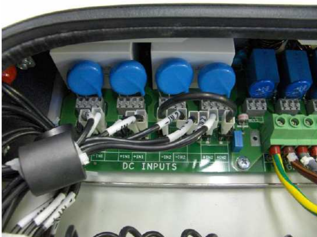
Slika 13 – Priključki, potrebni za kratkostično vezavo kanala 2
